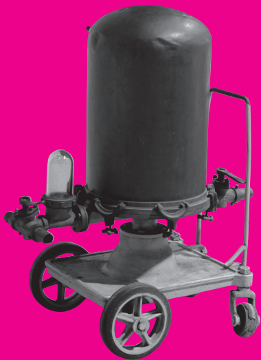
台車付きの濾過器。濾過器にはさまざまな形のものがあり、昔の材質は銅製だったが、現在はステンレス製が主流になっている。
